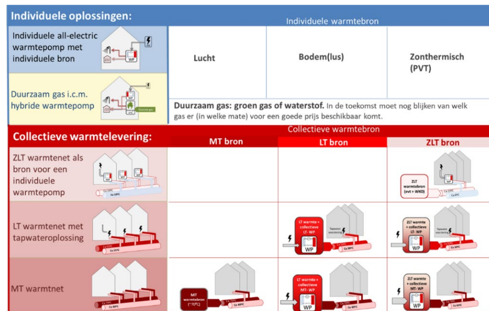
Figuur 6. Overzicht technische oplossingen voor verwarmen.
